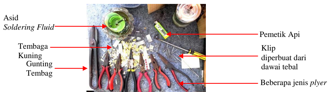
Gambar 7: Bahan Dan Peralatan Pembuatan Blok Batik Tembaga
