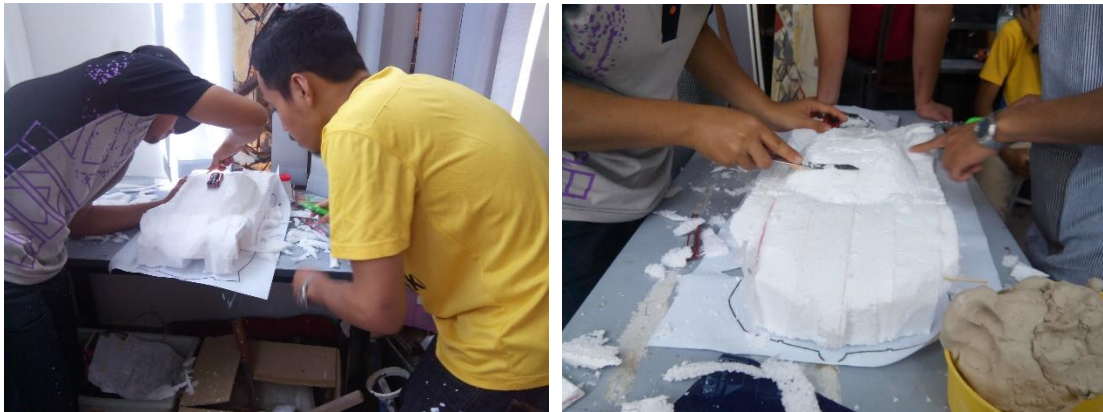
Gambar 1 Proses penghasilan kerangka dengan menggunakan polistirin.
