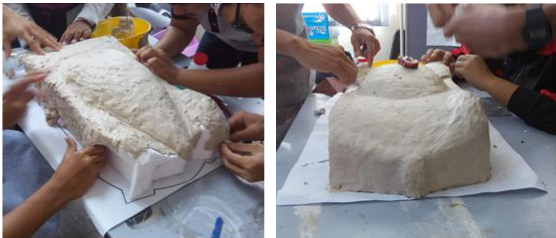
Gambar 2 Proses menampal lapisan pertama
