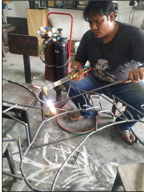
Rajah 4. Proses melentur besi menggunakan oxyacetylene
